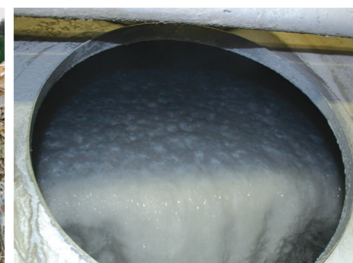
Ein Brei aus aufgeweichtem Papier und Zellulose steht am Anfang der Produktion.
