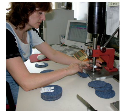
Qualitätskontrolle: Während des Fabrikationsganges werden laufend Proben entnommen und mit den Soll-Werten verglichen.
